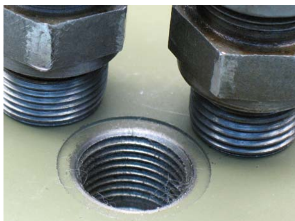
Bild 1: Zum Verwechseln ähnliche metrische und zöllige Einschraubzapfen
